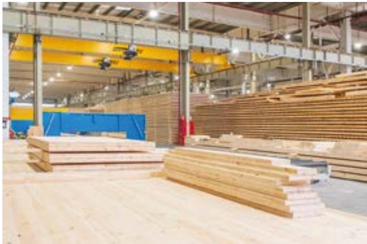
Будівельна лінія панелей Rezult CLT (Cross-Laminated Timber) - дерев'яні панелі, виготовлені з ламінованих шарів суцільної або оптимізованої (зрошененої) деревини, де кожен шар укладається перпендикулярно іншому.
