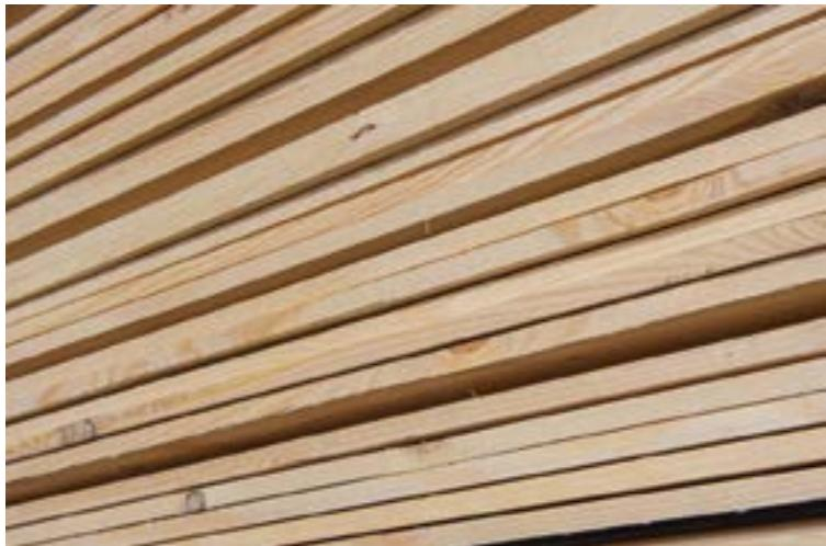
Пиломатеріали – продукція, яка виготовляється шляхом поздовжнього розпилювання кругляку деревини.
