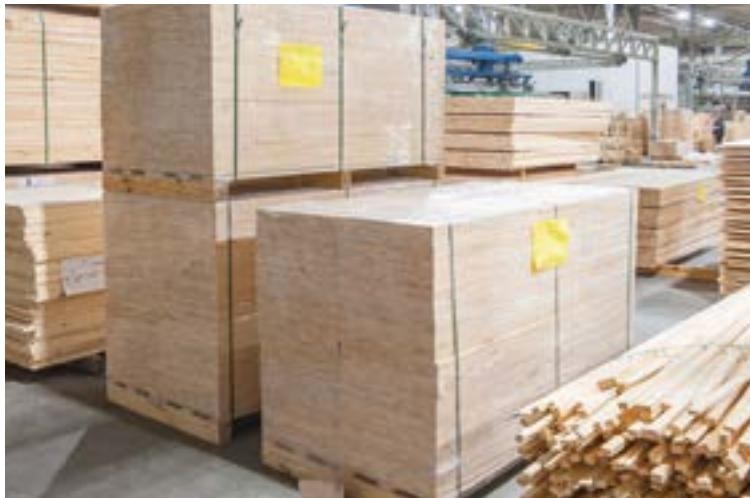
Клеєні панелі — це відносно широкі та тонкі неконструкційні вироби з деревини.
